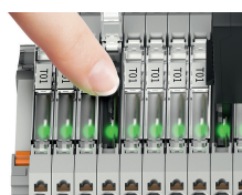
Konfiguration über Drück- und Schiebeschalter
